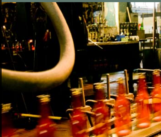
Met laserstralen wordt gecheckt of het schroefdraad van de nog roodgloeiende flessen in orde is.
